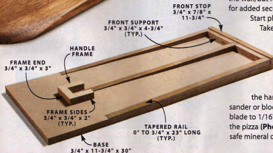
Fig. A Tapering Sled
